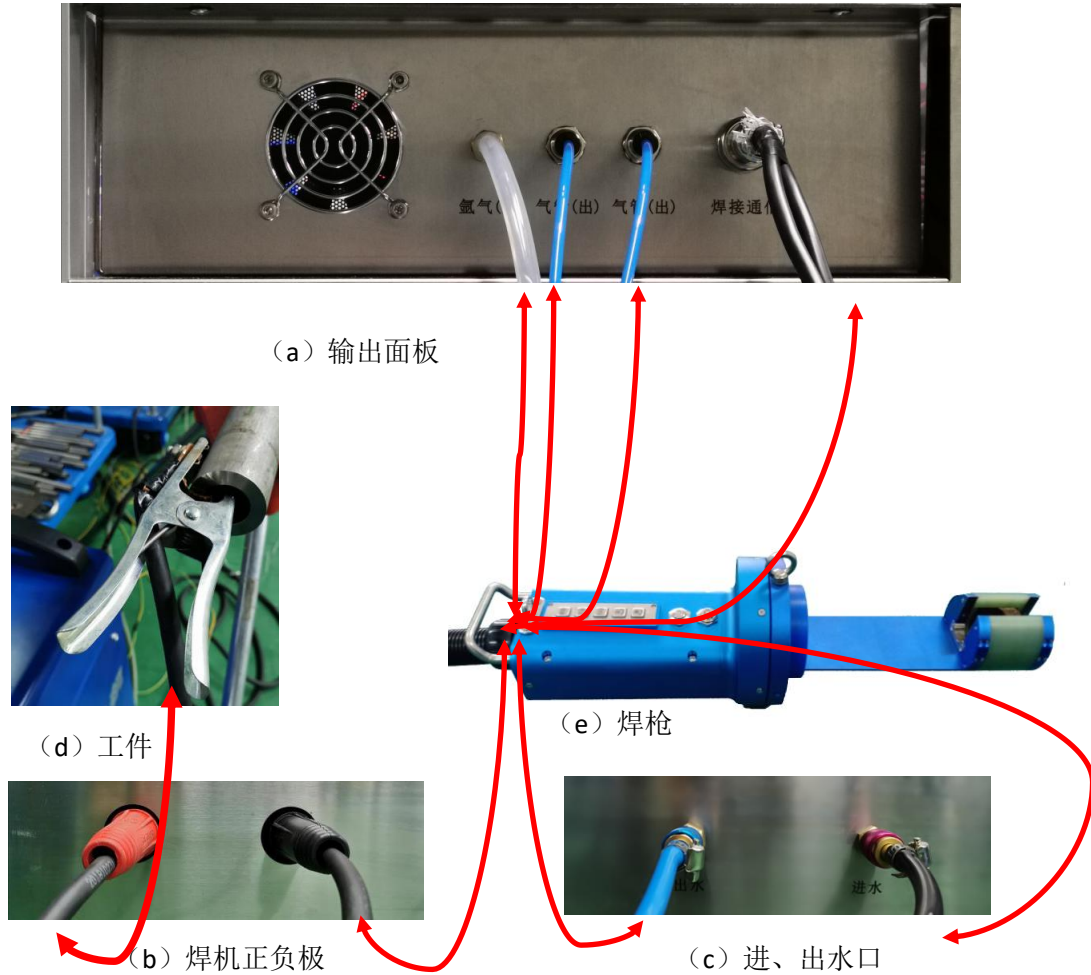
图 3.10 输出面板接线细节
